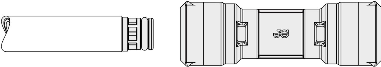
Wenn das Rohr vollständig eingesteckt wurde, ist es durch das Sichtfenster des Verbinders zu sehen.
